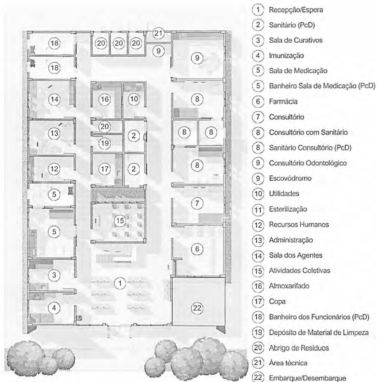
Figura 3 – Esquema para melhor compreensão da distribuição interna dos ambientes.
